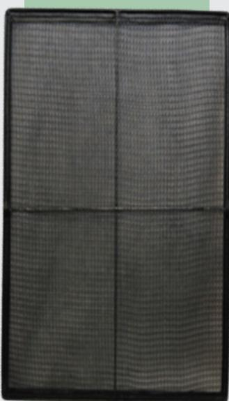
Os filtros laváveis eletrostáticos são fabricados com elemento filtrante de polipropileno na cor preta, às vezes, chamados de filtros de nylon. Sua moldura é composta por barras de aço e um revestimento de courvin. Sua classificação de filtragem é G1, conforme ABNT NBR 16101.
