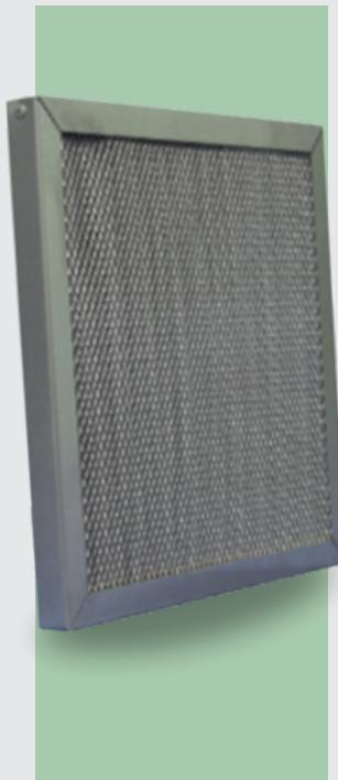
Os filtros metálicos com classe de filtragem G0 e G1, conforme ABNT 16101, são indicados para sistemas com elevada concentração de pó ou gordura, pois retêm o particulado grosso.
